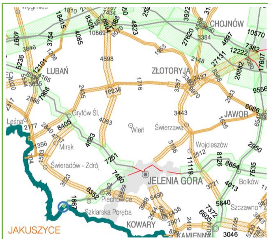
Rysunek 13. Wyniki pomiaru ruchu drogowego - drogi wojewódzkie i krajowe w rejonie AJ, 2015 r., kolor zielony oznacza pomiar dla dróg krajowych i autostrad, kolor pomarańczowy – dla dróg wojewódzkich; źródło GDDKiA
